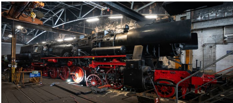
Bereits 2023 nutzten wir die Achssenke im Sächsischen Eisenbahnmuseum Chemnitz-Hilbersdorf, um die Achsstichmaße von 52 8141-5 zu korrigieren. (Foto: Bernd Hahn)
