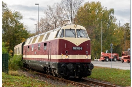
Lok 118 552-9 sorgt für Reisegeschwindigkeiten von bis zu 120 km/h. (Foto: Bernd Hahn)
