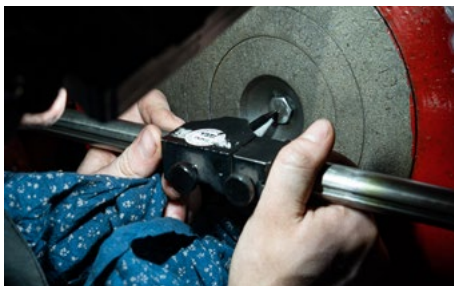
Für die Achsstichmaße muss eine Toleranz von weniger als 0,3 mm eingehalten werden. (Foto: Bernd Hahn)
