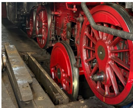
Mit einer Achssenke können einzelne Achsen nach unten aus dem Rahmen abgesenkt und zur Bearbeitung ausgebaut werden. (Foto: Nils Metzger)
