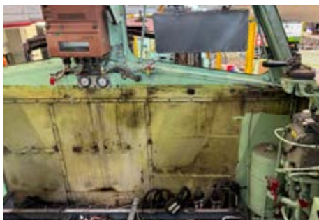
Um das Führerhaus abheben zu können, mussten vorher die Führerstände ausgebaut werden. (Foto: Philipp Beckel)
