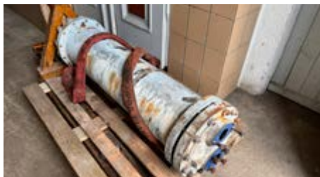
Einen altbrauchbaren Motorölwärmetauscher können wir mit eigenen Mitteln aufarbeiten.
