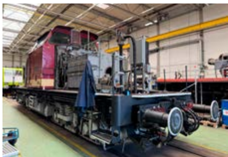
Unter den Vorbauten befinden sich der Motor und die Hilfsaggregate. (Foto: Phillip Beckel)
