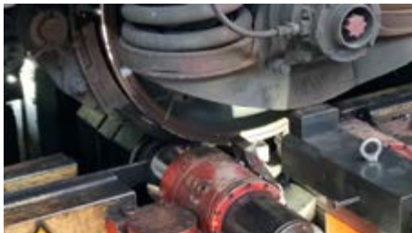
Ohne die Achse auszubauen, wird der Radreifen von unten abgedreht. (Foto: Manuel Drechsel)
