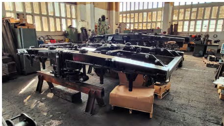
Demontierter Drehgestellrahmen des Bghw-Wagens. (Foto: Maximilian Schöne)
