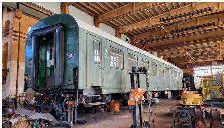
Für die vorgeschriebenen Arbeiten werden die Wagen aufgebockt. (Foto: Maximilian Schöne)
