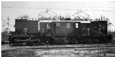
Speziell für das Schlesische Netz wurden schwere Elektroloks der späteren Baureihe E91.3 beschafft. (Foto: Werksfoto Siemens-Schuckert-Werke, 1915)
