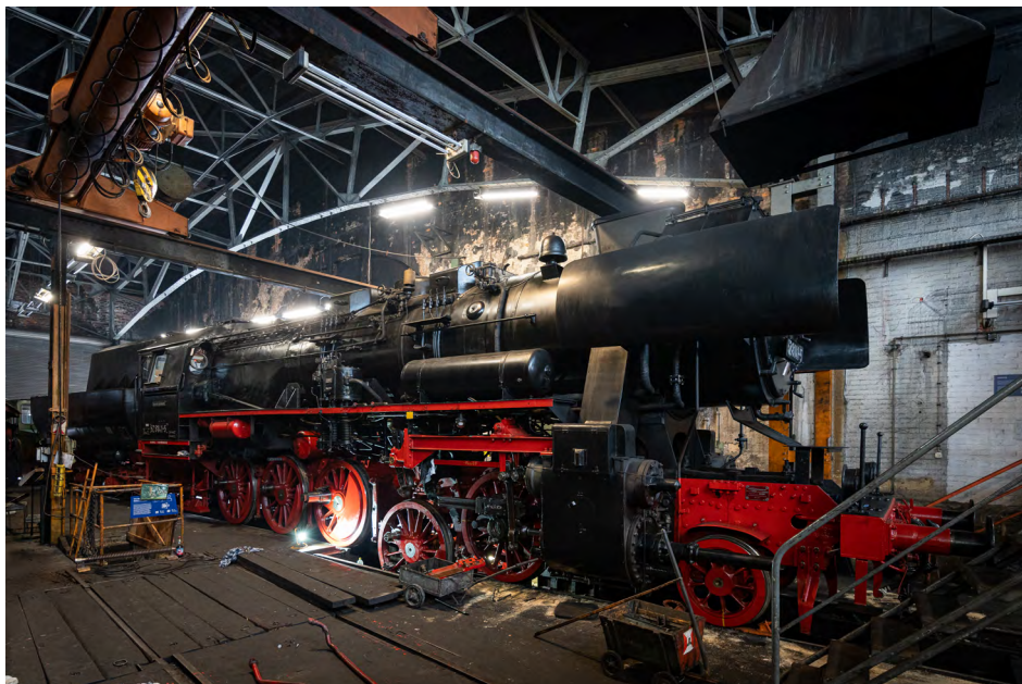
Mit Hilfe der Achssenke im Sächsischen Eisenbahnmuseum Chemnitz-Hilbersdorf können die Fehlersuche und die notwendigen Arbeiten am Fahrwerk von 52 8141-5 erledigt werden. (Foto: Bernd Hahn)
