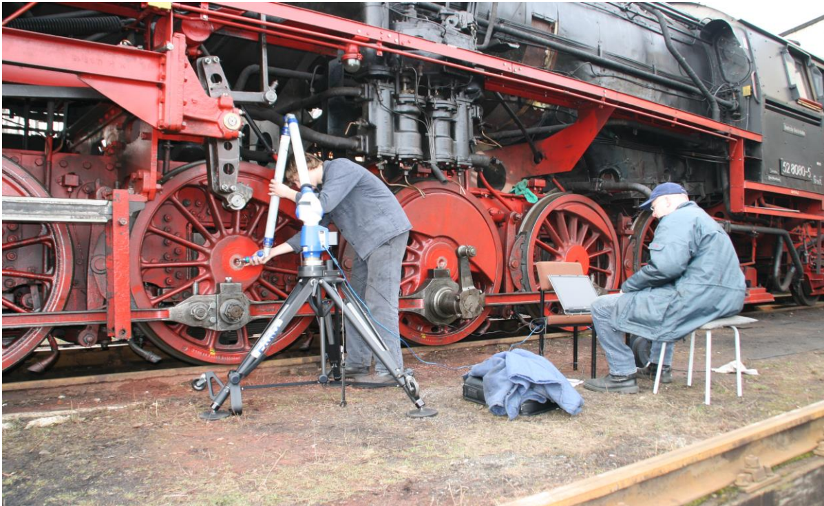
Vermessen der Achsstichmaße und der äußeren Steuerung der 52 8080-5 am 24.02.07 (Foto: OSE)
